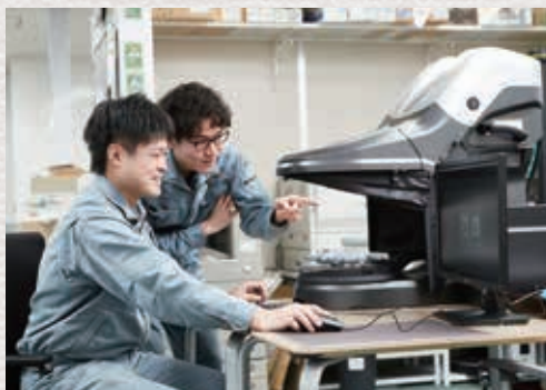
スキャナー型三次元測定器による検査。
