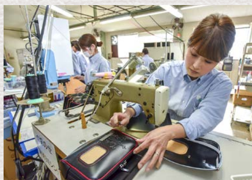
全体の作業が円滑に流れるよう400ある工程を30のゾーンにまとめ、スキルを考慮しながら作業者の担当と配置を考えました。
